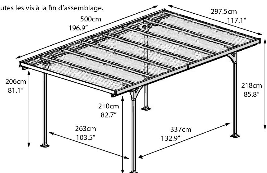
Ne pas serrer les vis et les écrous (411 & 412) jusqu'à la fin du processus d'assemblage. Ces deux icônes indiquent si le serrage de vis est nécessaire ou non.
