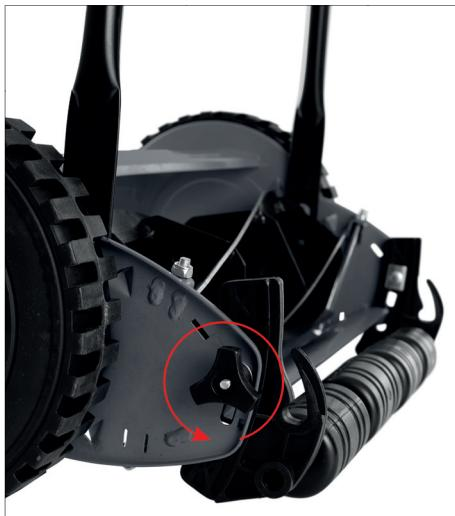
Løft håndklipperen op på et arbejdsbord, og sæt et stykke papir ind mellem knivene og afklipningskanten (B).
