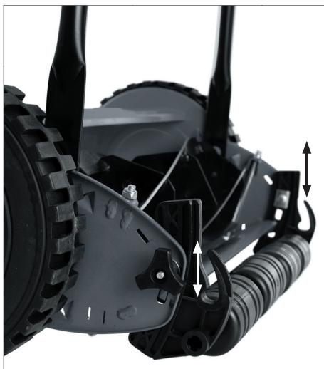
Tarkista säännöllisesti leikkumekanismin oikea säätö.
