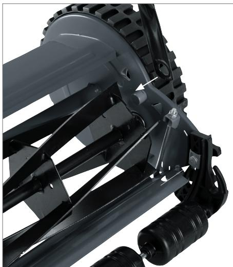
Kontroller, at alle skruer og møtrikker er spændt forsvarligt.
