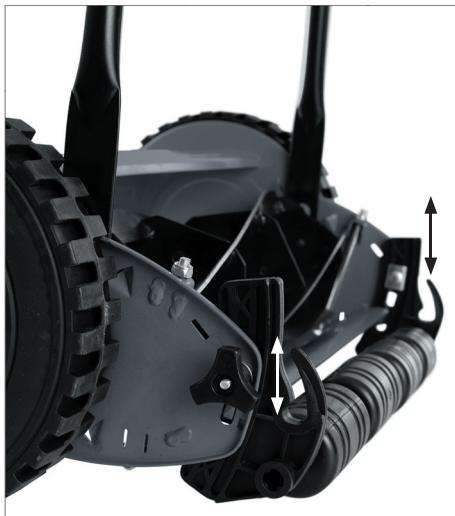
Kontroller regelmæssigt, at klippemekanismen er indstillet korrekt.
