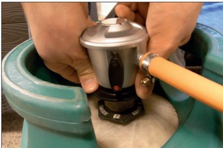
Regulatorn måste vara åtdragen så att det är möjligt att lyfta gasolflaskan bara genom att hålla i regulatorn.
