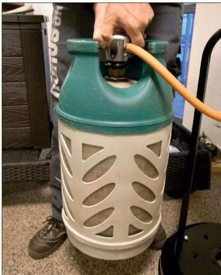
Hinweis: Dies gilt nicht für den schwedischen Druckregler, der einfach an den Gaszyylinder geschraubt wird.
