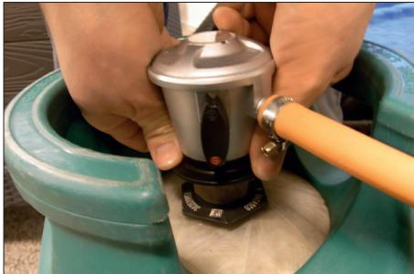
Der Druckregler muss so dicht sein, dass Sie den Gaszyylinder einfach am Druckregler fassen und anheben können.
