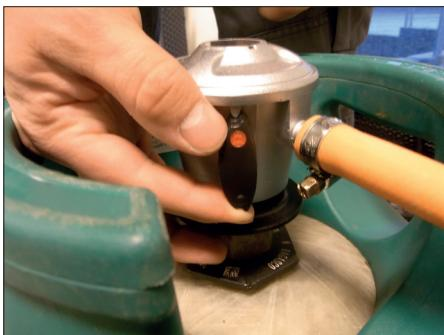
Tryck på justeringsknappen och vrid den motsols till punkten efter positionen "PILOT" (se pilen på bilden).
