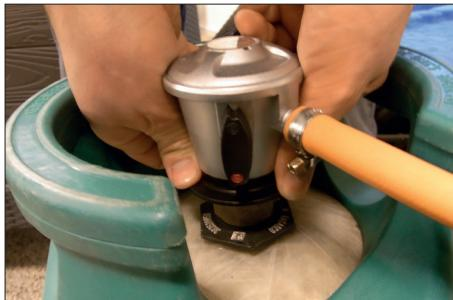
Regulatoren skal sidde så fast, at det er muligt at løfte gasflasken ved kun at holde fast i regulatoren.
