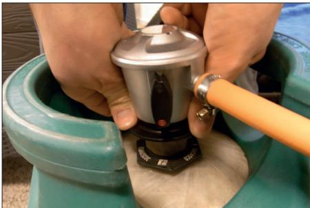
Säätimen on oltava tukevasti paikallaan, jotta kaasupulloon voi nostaa pitämällä kiinni vain säätimestä.
