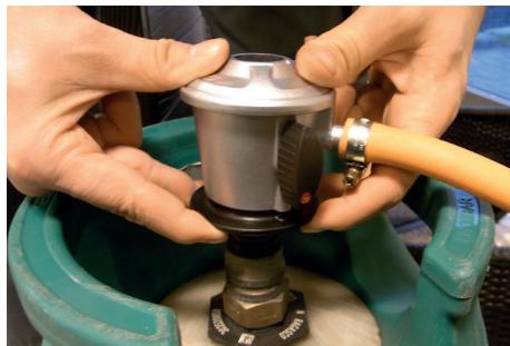
Drücken Sie nun den Ring ganz nach unten, sodass er sich erkennbar und sicher am Gaszyylinder verriegelt.
