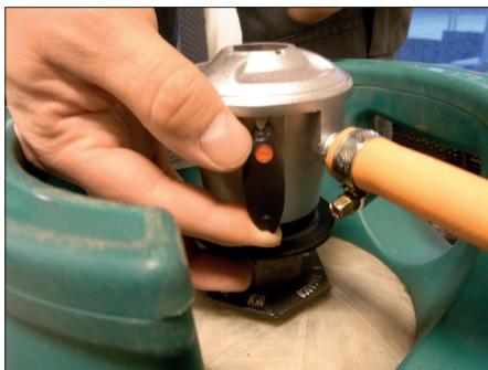
Vajutage reguleerimisnuppu ja keerake seda vastupäeva punktile pärast "PILOT" positsiooni (vt nool joonisel).
