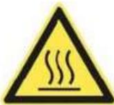
26. **Advarsel, varm overflade.**
