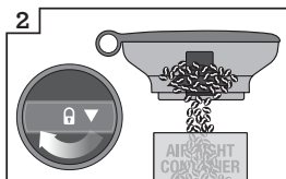
Tenez la trémie au-dessus du récipient et tournez la molette pour libérer les grains dans le récipient
