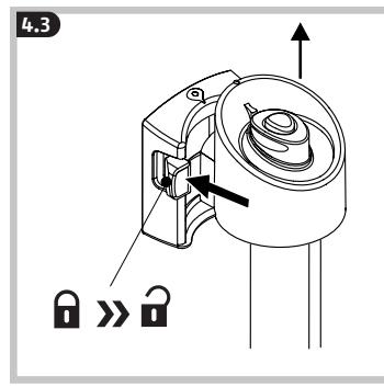
**DE** Richten Sie die Markierungen am Rollo auf die Pfeilanzeige am oberen Verriegelungsbügel aus (4.1). Richten Sie den unteren Teil des Rollos auf den unteren Verriegelungsbügel aus. Rasten Sie das Rollo ein, bis Sie ein Klickgeräusch hören (4.2). Um das Rollo aus der oberen Verriegelungshalterung zu lösen, drücken Sie den Riegel in Richtung Wand und ziehen Sie das Rollo nach oben, um es zu lösen (4.3).
