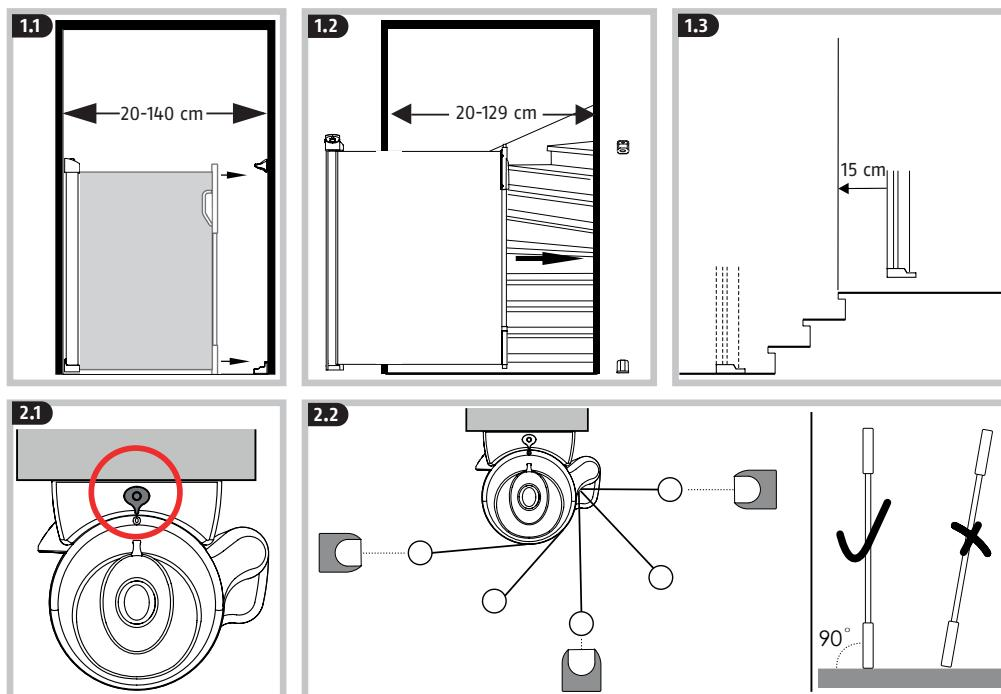
**(DE)** Das Rollo kann in verschiedenen Winkeln ausgezogen werden. Legen Sie die gewünschte Position vor der Montage fest (2.2). Hinweis: Das Tür- und Treppenrollo muss sicher und gerade an Wänden, Türrahmen oder Pfosten montiert werden. Schräge Montage führt zu einer Blockade des Schließsystems.
