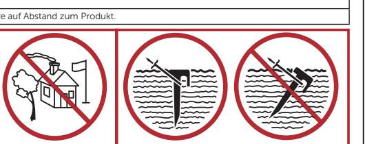
PFÄHLE MÜSSEN GERADE EINGESCHLAGEN WERDEN, BIS SICH DIE SPITZEN DES PFÄHLS UNTER DER ERDBEFLÄCHE BEFINDEN. PFÄHLE NICHT IN EINEM WINKEL EINSCHLAGEN.
