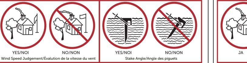
STAKES ARE TO BE DRIVEN STRAIGHT DOWN UNTIL THE TOP OF THE STAKE IS BELOW GROUND LEVEL. DON NOT DRIVE STAKES AT AN ANGLE.
