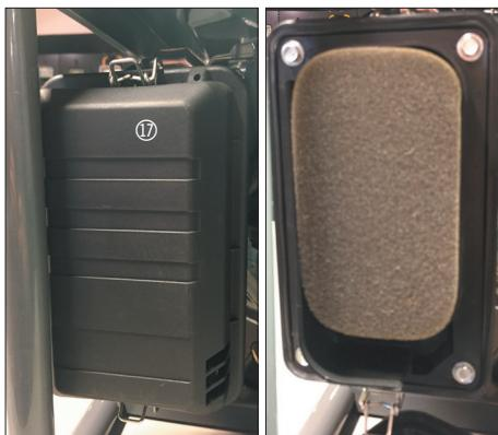
Verwijder het filterelement.
