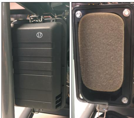
Ta bort filterelementet.
