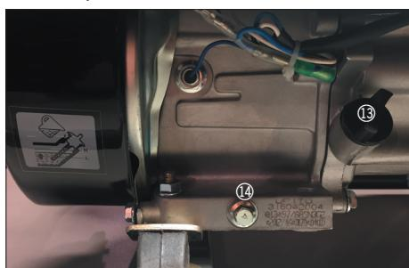
Open de oli klep en schroef de afvoerdop los. Kantel de generator en voer de gebruikte motorolie af. Voer de gebruikte olie in overeenstemming met de lokale wet- en regelgevingen af.
