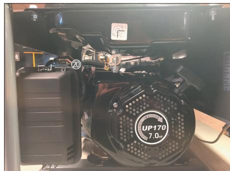
Zet de gasklep (20) in de stand OFF (UIT) om het benzinemengsel rijker te maken indien de motor koud is. Zet de gasklep in de stand ON (AAN) als de motor warm is.
