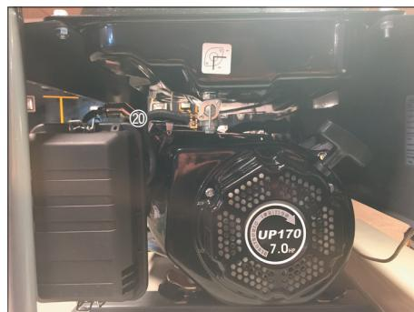
Se il motore è freddo, per rendere più carica la miscela di benzina portare la valvola dell'aria (20) nella posizione di OFF. Se invece il motore è caldo regolare la valvola dell'aria su ON.
