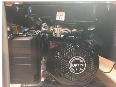
Placez le starter (20) sur la position OFF pour enrichir le mélange carburant si le moteur est froid. Placez le starter sur la position ON si le moteur est chaud.
