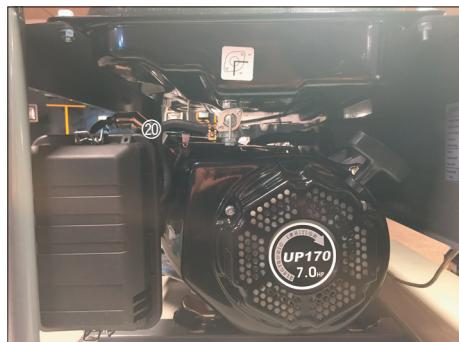
Seadke kütusesegu rikastamiseks öhuklapp (20) asendisse OFF (väljas), kui mootor on külm. Seadke öhuklapp asendisse ON (sees), kui mootor on soe.
