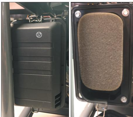
Ta ut filterelementet.
