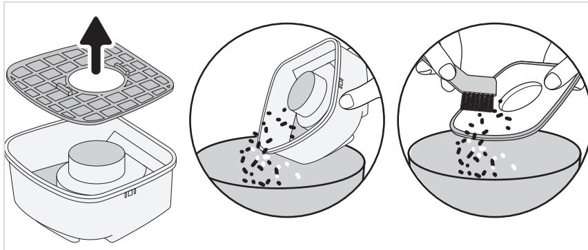
Bei Bedarf Staubbehälter und Filter nass reinigen:
