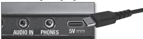
**ACHTUNG** - Das Isolierschutzmaterial am Adapter muss regelmäßig auf eventuelle Schäden am Kabel, am Stecker, am Isoliermaterial sowie an anderen Teilen überprüft werden. Bei etwaigen Schäden darf das Instrument bis zur Behebung evtl. Mängel nicht mehr mittels NetzadAPTER verwendet werden.
